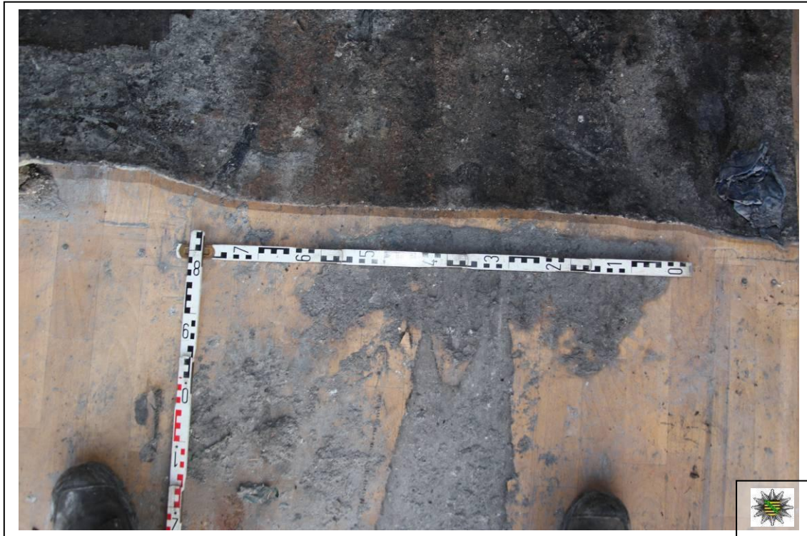
Bilder 689 und 690 Detailaufnahmen der Brandspuren, die auf dem Linoleum festgestellt wurden.
