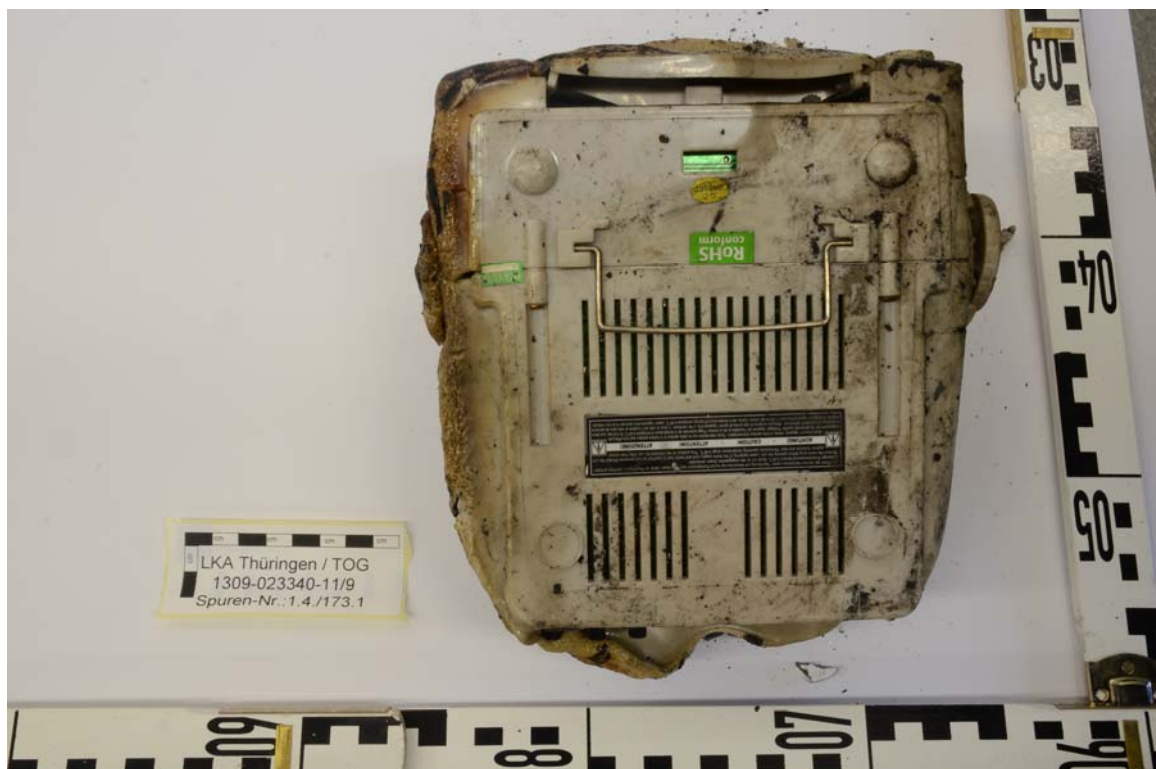
Sp.1.4_173.1 Monochrommonitor mit Brandspuren (unten)
